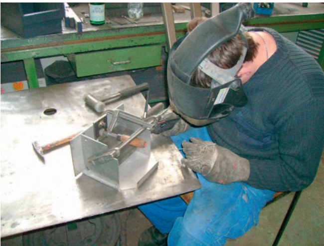
Abbildung 8: Bau der Tragekästen aus Edelstahl zum Einsetzen und Absenken der Batterien in das Bojenrohr.
