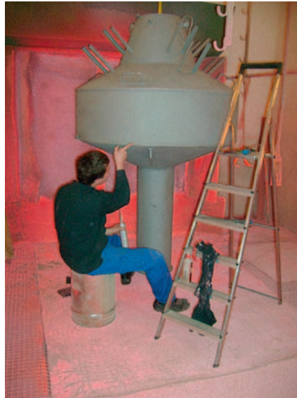
Abbildung 6: Grundierung und Vorbereitung des Schwimmkörpers (hier mit bereits montierten Haltevorrichtungen für die vier 24wP-Solarpanel) zur abschließenden Lackierung.
