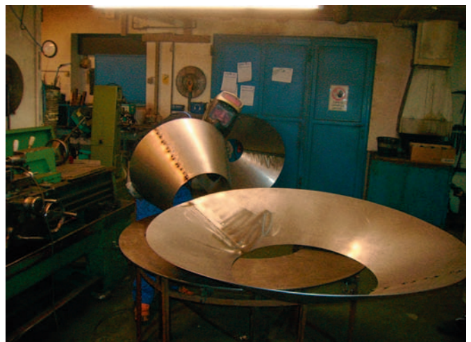
Abbildung 4: Erste Stahlarbeiten zur Formung des Schwimmkörpers in der Werkstatt der Fa. Weiseler Bojenbau.
