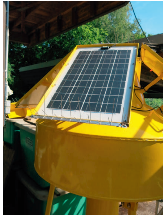
Abbildung 40: Boje mit nachträglich montierten 48 Wp-Solarpanelen.
