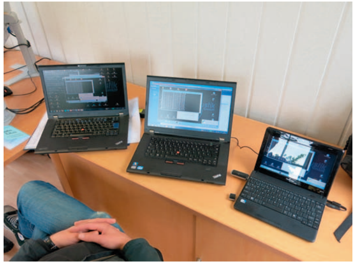
Abbildung 17: Konfiguration der beteiligten PC's zur Kommunikation des Senders (Boje) mit den Empfänger-Stationen. Rechts das in der Boje verbaute PC-Netbook.
