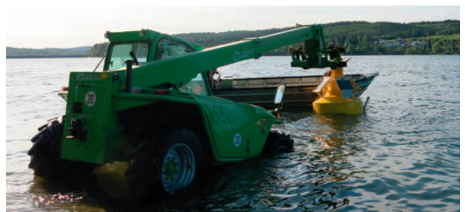
Abbildung 21: Erste Wasserung der Fischmessboje zu Testzwecken und einer ersten Datenerfassung an der Möhnetalsperre am 06.08.2013 mit Hilfe eines Frontladers.
