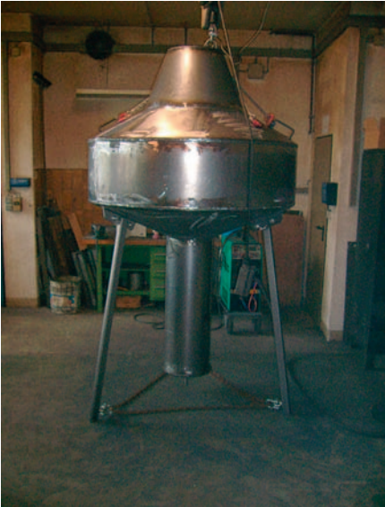
Abbildung 5: Unlackierter Bojenkörper nach Fertigstellung eines maßgeblichen Teils der Stahlarbeiten mit Aufnahmerohr für die Batterien (mittig) und Standfüßen zur Unterstützung der ausstehenden Einbauten und Montagen.
