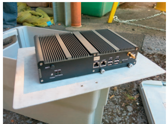
Abbildung 41: Industrie-PC mit Hardware-Schnittstellen montiert auf Einschubvorrichtung vor dem Einbau in den Bojenkörper.
