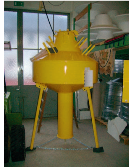
Abbildung 7: Lackierter Bojenkörper nach Fertigstellung vor dem Einbau der Batterien und Verkabelung.
